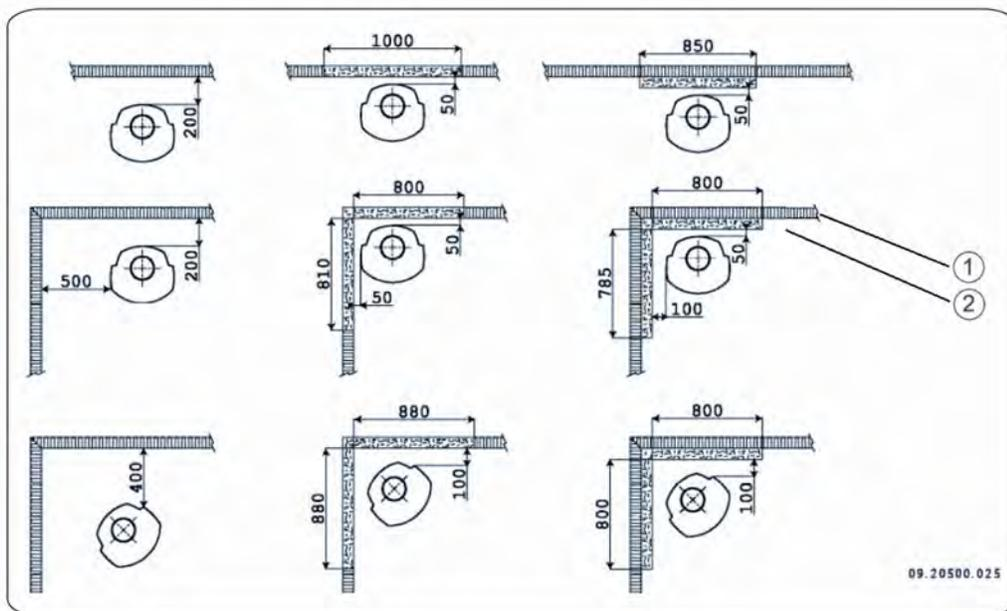
Wenn der Abstand des Anschlussrohrs zu brennbarem Material geringer als 300 mm ist, muss es abgeschirmt werden.
